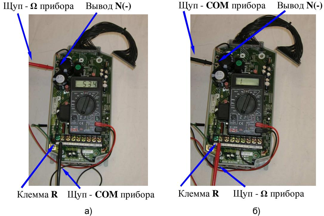
Рис 4.8. Диагностика матрицы IGBT относительно шины N(-).
