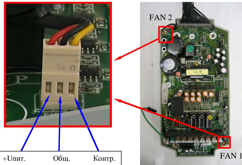
Рис. 4.12. Диагностика вентиляторов.
