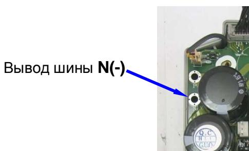
Рис. 4.7. Вывод шины **N(-)** на плате драйверов
