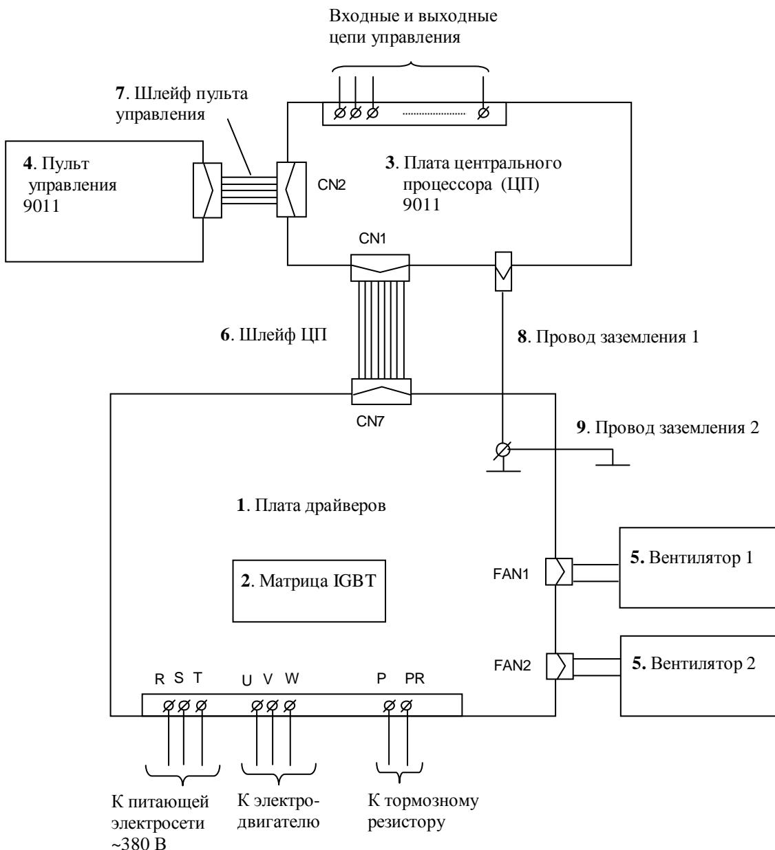
Рис. 4.2. Блок-схема преобразователей частоты **EI-9011-001Н...007Н**
