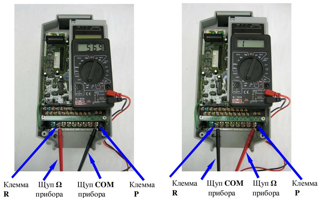
Рис 4.5. Диагностика матрицы IGBT относительно шины Р.
