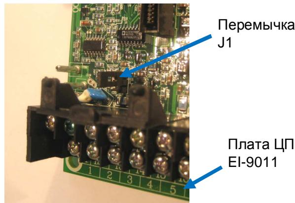
Рис. 4.15. Перемычка J1 на плате ЦП EI-9011.
